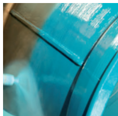
Nanášení práškového epoxidu pistolí
