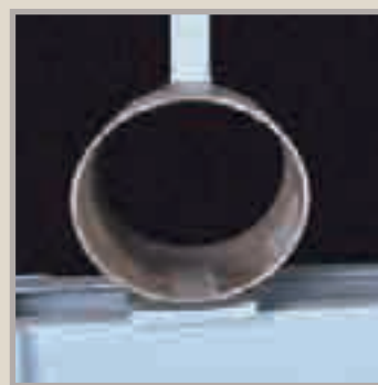
Kruhová pevnost sklolaminátové trubky.
