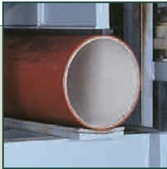
Kruhá pevnost trubky z tvárné litiny.
