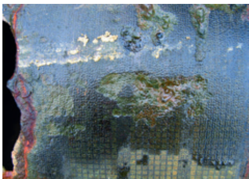
Abb. 4 – Beispiel für lokale mikrobiologische Korrosion (li); Voraussetzungen für mikrobiell beeinflusste Korrosion durch sulfatreduzierende Bakterien (re)
