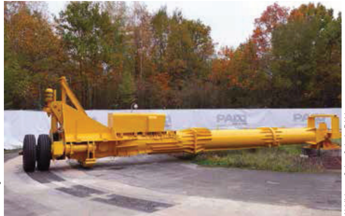
Prüfeinrichtung „Karusselltest“ für Schachtabdeckungen und Aufsätze.
