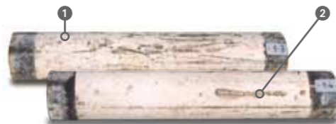
Umhüllung aus Zink 200g/m 2 + Bitumen-Deckbeschichtung 80µm
