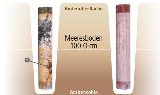
Umhüllung aus Zink 200g/m 2 + Bitumen-Deckbeschichtung 80µm
