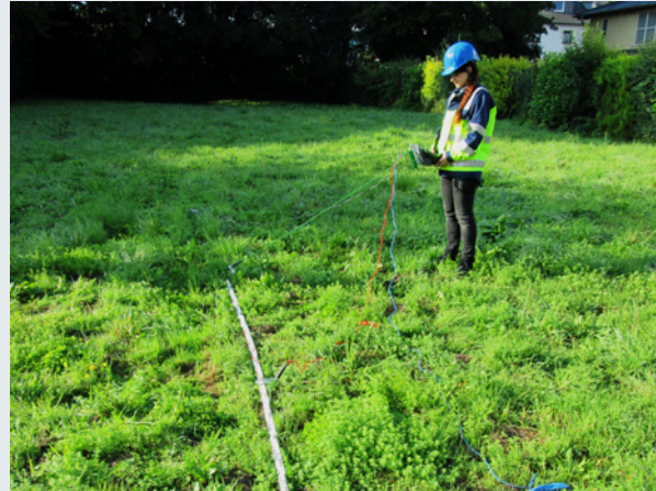
Bild 4: Bodenwiderstandsmessung im Feld
