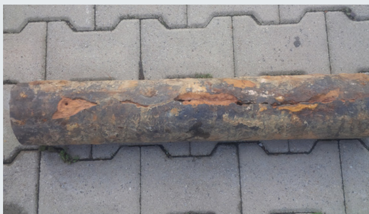
Bild 1: Stark korrodiertes Leitungsrohr aus Grauguss
