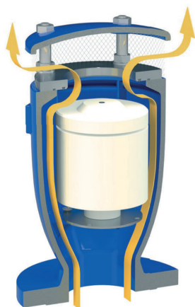
Evacuación de aire al llenar la conducción
