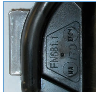
Obturador de FD revestido de elastómero EPDM. Marcado UNE-EN 681-1.
