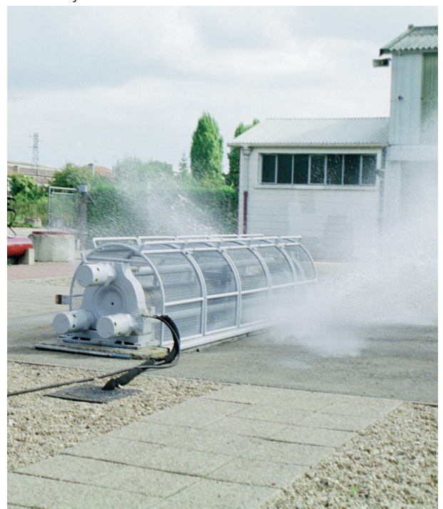
Essai destructif de pression sur tuyau DN 250
