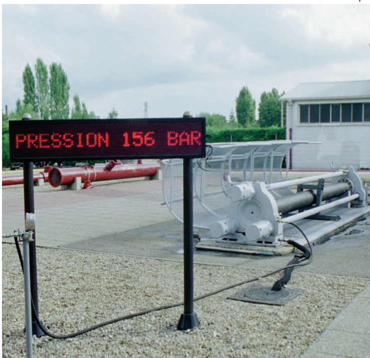
Essai destructif de pression sur tuyau DN 250
