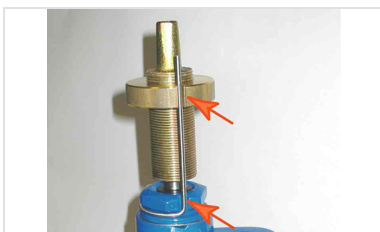
7- Tige en place dans l'encoche de l'écrou et de l'index
