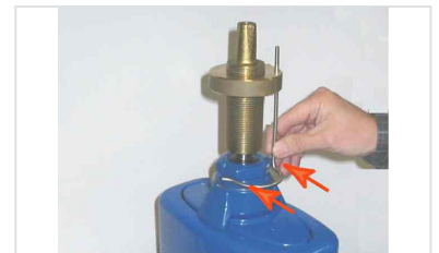
6- Montage de la tige dans la gorge de l'écrou
