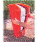
Mise en place des 2 petites vis et serrage avec la 2 ème clé
