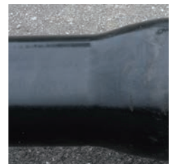
Aspect du revêtement TT PE pour un DN ≤ 500
