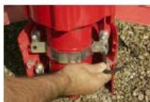
Maintenir le coffre « debout » à main gauche, disposer le 1/2 collier avant supérieur et serrer les vis avec la clé disposée dans le sachet
