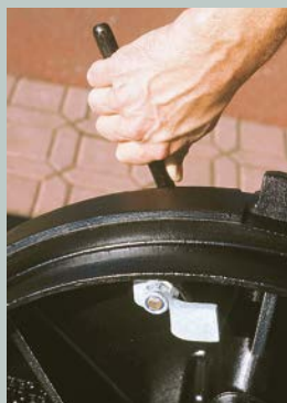
→ Système de verrouillage 1/4 de tour
