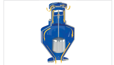
Entrée d'air à grand débit d'air pendant la vidange
